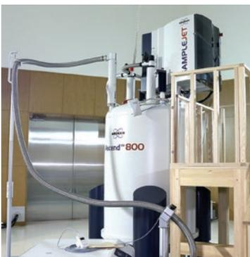
2機の800MHzの核磁気共鳴(NMR)装置を有しています。極低温高感度検出器を備えており、タンパク質の立体構造解析、薬物等との相互作用解析等に威力を発揮します。また、約500検体の自動測定が可能なおトサンプルも装備されており、効率的なりガンドスクリーニングやメタボローム解析が可能です。
