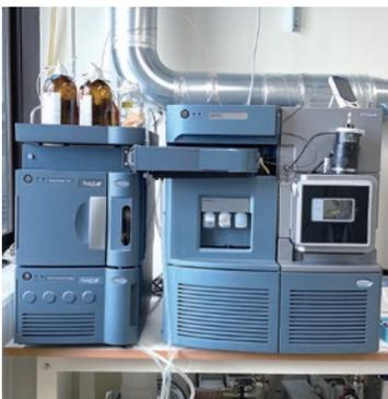
超高性能液体クロマトグラフィーと連結した質量分析装置であり、薬物などの試料を高速かつ高感度で分離・分析できる装置です。質量分析側は三連四重極型となっており、試料の分子量(質量電荷比)の違いだけでなく、不活性ガスとの衝突で生じたフラグメントの分子量の違いも利用することで特異的な検出が可能となっています。
