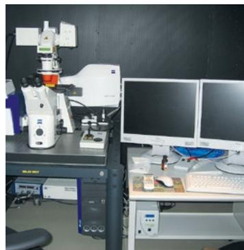
コントラストの良い共焦点画像を取得でき、試料を高詳細・高速で観察できます。細胞内の任意の分子に光刺激を与え、その挙動を追跡することもできます。この装置により、細胞内のタンパク質や核酸の空間配置を高精度に画像化したり、ダイナミックに起こっている分子の挙動を高速で観察することが可能となりました。
