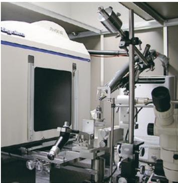
結晶構造解析用のX線を発生させる装置。タンパク質の立体構造を決定するのに使われます。窒素ガス吹き付け装置も装備されています。検出部には3枚のイメージングプレートを搭載しており、露光、読み取り、消去の並行処理ができるため、迅速な回折データの収集が可能です。
