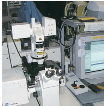
蛍光相関法とはレーザー光を高性能のレンズで絞り、溶液や生きた細胞中の蛍光色素の蛍光強度の揺らぎを利用して、分子の大きさや数を解析する手法です。レーザー顕微鏡と組み合わせ、高い空間分解能を有したまま細胞中を観察し、分子の動きや数の変化、分子間相互作用を解析することができます。
