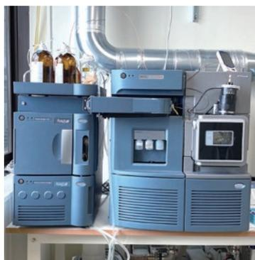
超高性能液体クロマトグラフィーと連結した質量分析装置であり、薬物などの試料を高速かつ高感度で分離・分析できる装置です。質量分析側は三連四重極型となっており、試料の分子量 (質量電荷比) の違いだけでなく、不活性ガスとの衝突で生じたフラグメントの分子量の違いも利用することで特異的な検出が可能となっています。
