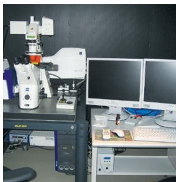
コントラストの良い共焦点画像を取得でき、試料を高詳細・高速で観察できます。細胞内の任意の分子に光刺激を与え、その挙動を追跡することもできます。この装置により、細胞内のタンパク質や核酸の空間配置を高精度に画像化したり、ダイナミックに起こっている分子の挙動を高速で観察することが可能となりました。
