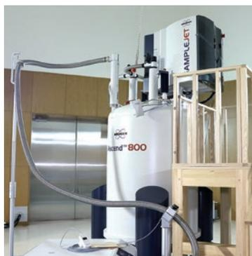
2機の800MHzの核磁気共鳴 (NMR) 装置を有しています。極低温高感度検出器を備えており、タンパク質の立体構造解析、薬物等との相互作用解析等に威力を発揮します。また、約500検体の自動測定が可能なおトサンプルも装備されており、効率的なりガンドスクリーニングやメタボローム解析が可能です。
