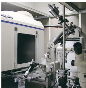
結晶構造解析用のX線を発生させる装置。タンパク質の立体構造を決定するのに使われます。窒素ガス吹き付け装置も装備されています。検出部には3枚のイメージングプレートを搭載しており、露光、読み取り、消去の並行処理ができるため、迅速な回折データの収集が可能です。
