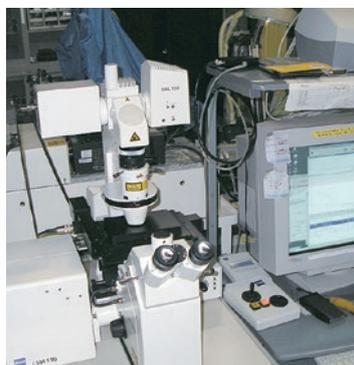
蛍光関連法とはレーザー光を高性能のレンズで絞り、溶液や生きた細胞中の蛍光色素の蛍光強度の揺らぎを利用して、分子の大きさや数を解析する手法です。レーザー顕微鏡と組み合わせ、高い空間分解能を有したまま細胞中を観察し、分子の動きや数の変化、分子間相互作用を解析することができます。
